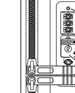
1. Réglez la combinaison sur la valeur par défaut. Par sécurité, vérifiez que vous pouvez pousser le contact à ouverture **A** vers le haut. Lors du réglage, les tirettes de la fermeture à glissière ne doivent pas se trouver dans le cadenas.
